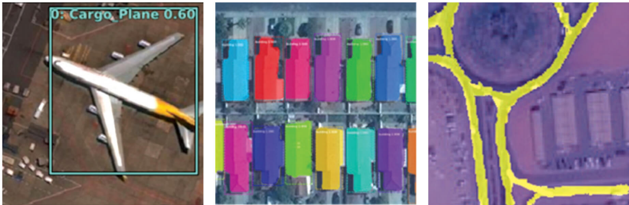
Rys. 4. Wyniki różnego rodzaju przetwarzania obrazów z wykorzystaniem Deep Learning: wykrywanie obiektów (po lewej), klasyfikacja obiektów (w środku) i klasyfikacja pikseli (po prawej). Źródło: www.esri.com
