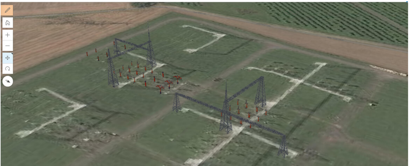
Rys. 4. Przetworzone w wyniku transformacji pliki IFC zostały wyświetlone w aplikacji ArcGIS Pro i udostępnione w ArcGIS Online w postaci lokalnej sceny internetowej
