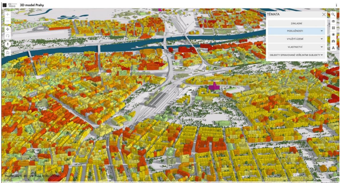
Rys. 5. Interaktywny widok 3D może służyć do analizy różnych zagadnień. W tym wypadku kolory odnoszą się do wysokości budynków.
