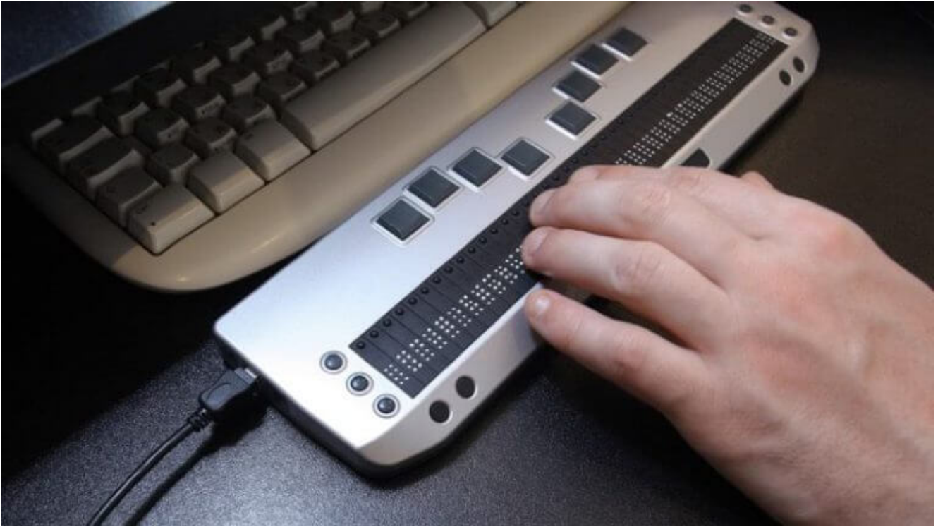
Rys. 3. Specjalne urządzenie Braille'a zainstalowane przy klawiaturze komputera pomaga osobom niedowidzącym odczytać słowa wyświetlane na ekranie.
