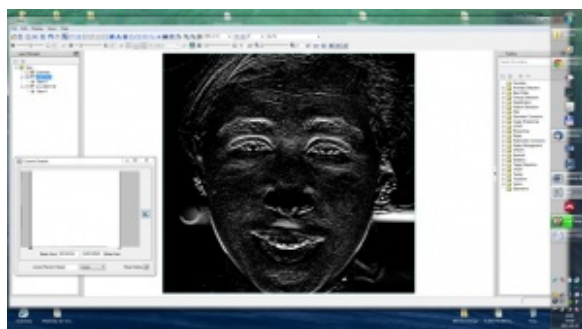
Rys.1. Pojedyncza klatka filmu uzyskana podczas rejestracji w trakcie jednego z eksperymentów przeprowadzonych przez zespół z Trójmiasta. Obraz został przetworzony przy wykorzystaniu filtru Prewita, umożliwiającego tzw. wykrywanie krawędzi.
